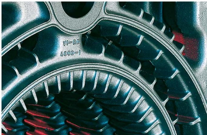
Guss-Segment des Vitorond 200, 440 bis 1080 kW
